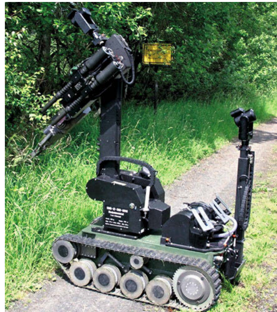
Fig. 43.8 tEODor, a telerobotic system for disarming of explosives (courtesy telerob Gesellschaft für Fernhantierungstechnik mbH, Ostfildern, Germany)
